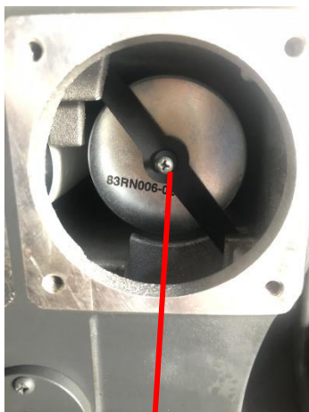
拆卸顶片将排气滤芯取出
