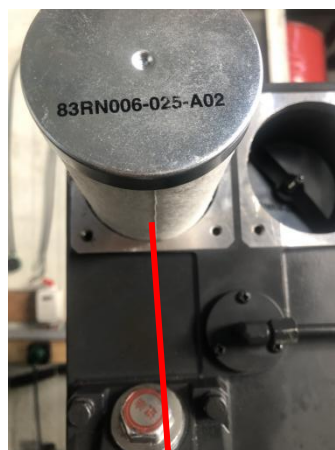
安装排气滤芯（注意密封线朝下安装）
